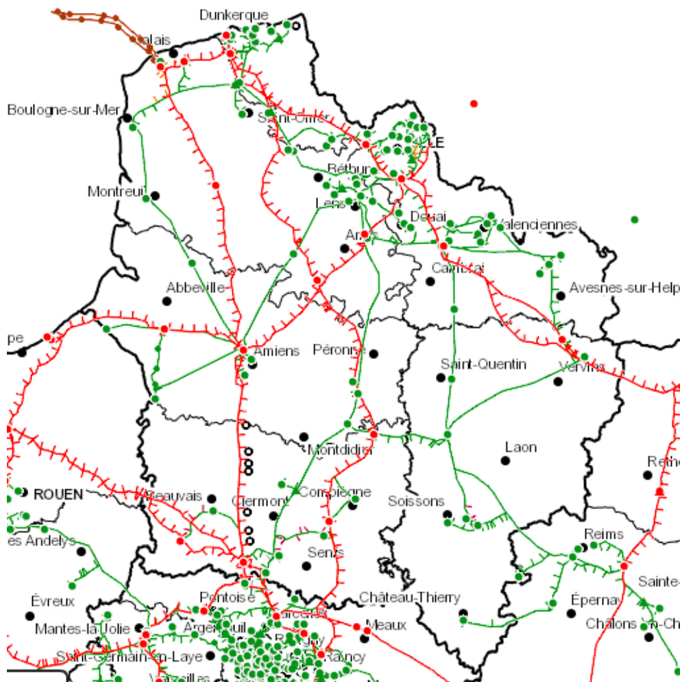
Réseaux 400 et 225 kV des Hauts-de-France
